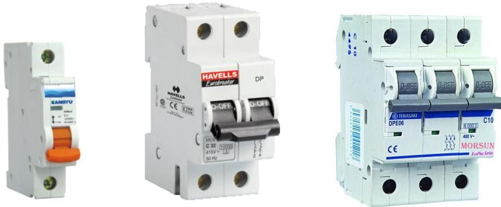
Cara kerja : jika tuas ON maka arus akan mengalir ke rangkaian. Dan apabila arus yang mengalir pada logam bimetal melebihi arus nominal nya, maka logam bimetal akan mengalami pembengkokan, sehingga kontak nya membuka dan menutup.
